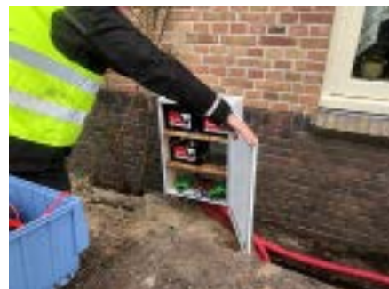
▲ Meetkast met accu's en de dataloggers.
